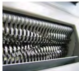
Ножи shreddеров EBA, изготовленные из первоклассной стали Solinger
